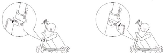
Wenn Sie der Meinung sind, dass die vordere Stange nicht fest genug ist, ziehen Sie die beiden Schrauben im Klappmechanismus mit dem Inbusschlüssel fest.
