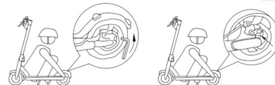
Jeśli uważasz, że hamulce są zbyt ciasne, użyj klucza sześciokątnego w kierunku przeciwnym do ruchu wskazówek zegara, aby poluzować śruby płyty dociskowej na gnieździe hamulca tarczowego. Zwolnij przewód hamulcowy, aby nieznacznie skrócić odsłoniętą długość i dokręć śruby płyty dociskowej. Jeśli uważasz, że hamulec jest zbyt luźny, zwolnij śruby na płycie dociskowej, przeciągnij linkę hamulca, aby nieznacznie wydłużyć jej długość, a następnie zablokuj śruby na płycie dociskowej.
