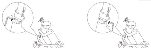
Jeśli uważasz, że przedni drążek nie jest wystarczająco napięty, użyj klucza sześciokątnego, aby dokręcić dwie śruby w mechanizmie składania.
